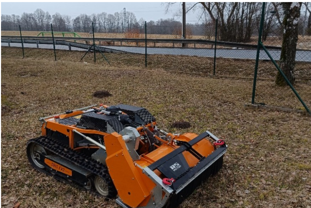
Svahová sekačka, tovární typ AS 1000 Ovis EVO RC.
