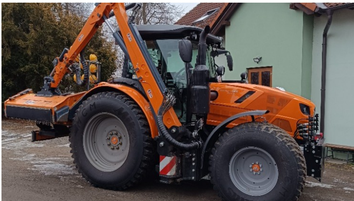
Traktor SAME VIRTUS 135RV shift se sekacím ramenem HYMACH TDHP 600TC.
