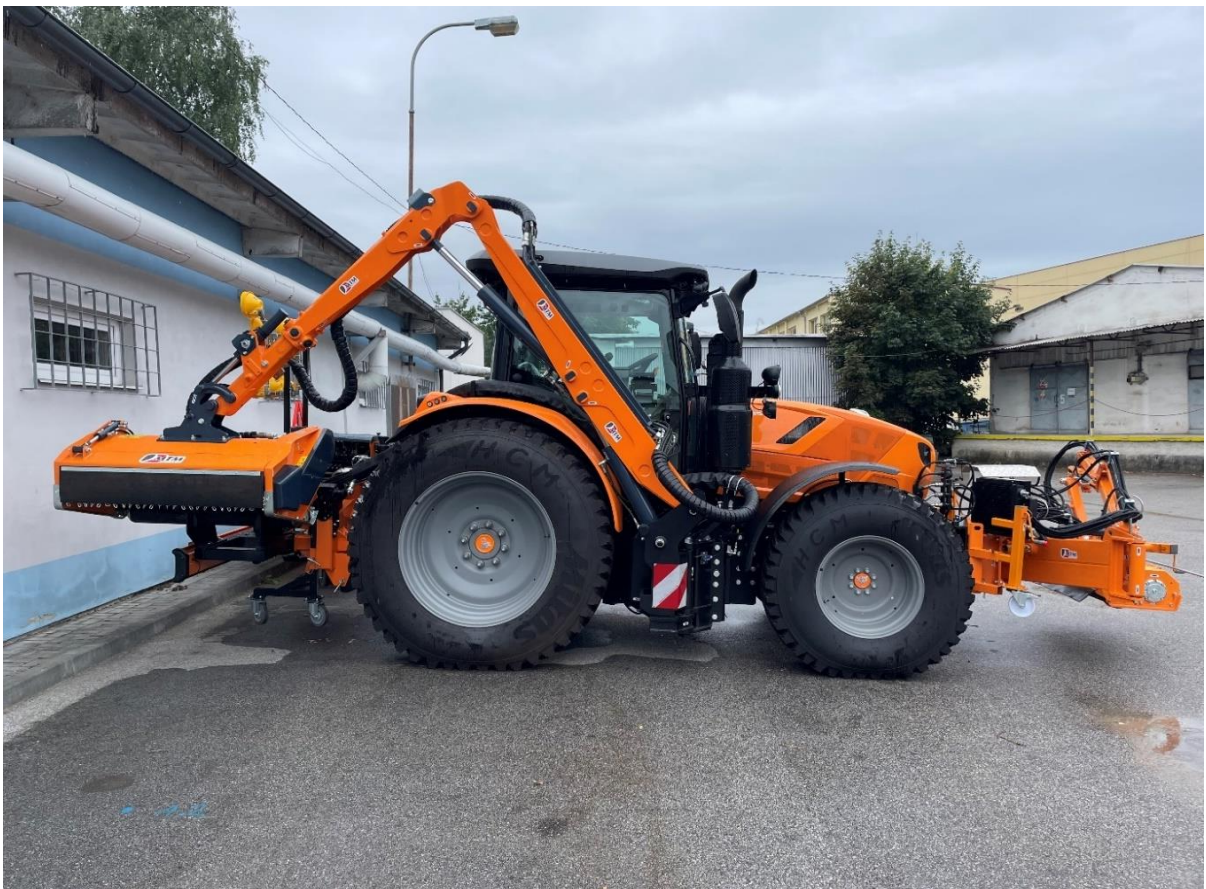
Obr.: Traktor kolový min. 95 kW + sekačka travních porostů ramenová
