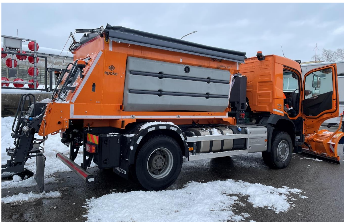
Obr.: Nákladní automobil 4x4 s nástavbou pro chemický posyp a s radlicí
