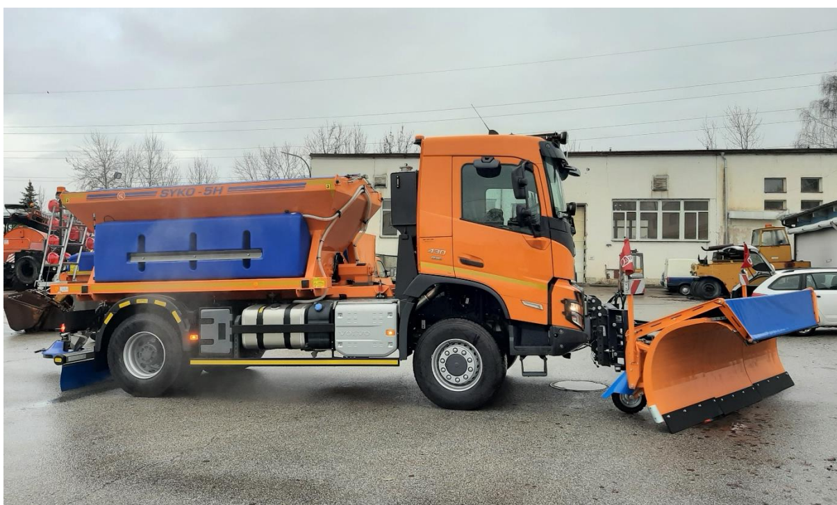
Obr.: Nákladní automobil 4x4 s nástavbou pro inertní posyp a s radlicí
